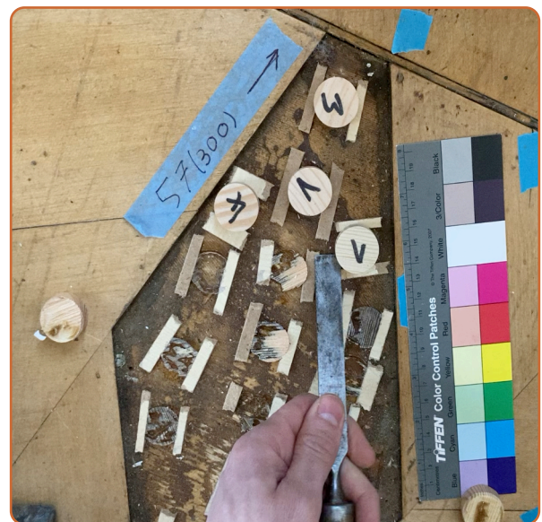
In-situ-Klebersuche auf verschmutztem Untergrund mit einer 2-mm-Spaltweite, und einer bis zu 0,5 mm starken Staubschicht. Schlossmuseum Quedlinburg.
