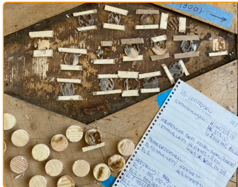
Zkouška lepení s mezerou 3 mm
