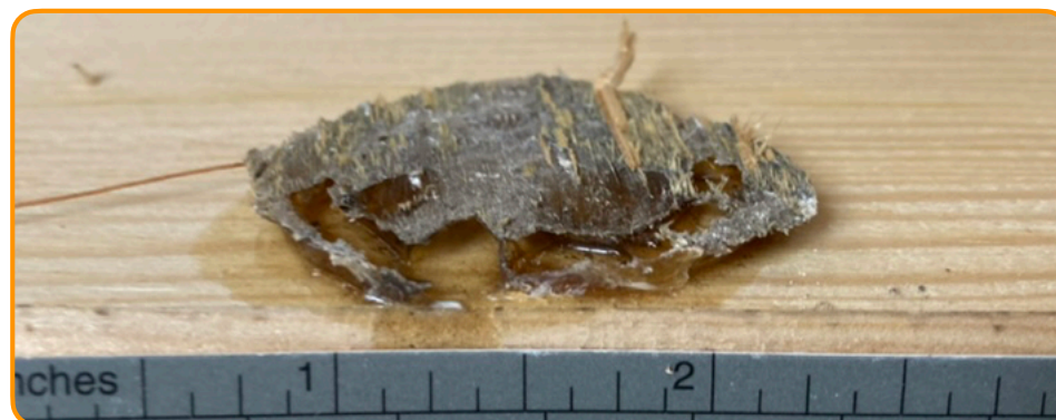
Zkouška lepení s mezerou 3 mm
