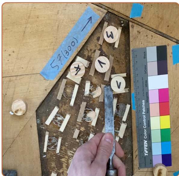
Zkoušky lepení in situ na neočištěném podkladě s mezerou 2 mm, zámecké museum Quedlinburg
