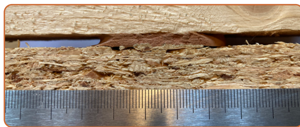
Zkouška podložení parkety injekčním tmelem. Šířka spáry 5 mm.
